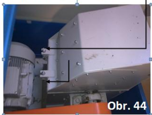
Skrutky uchytenia krytu rotora drvičky
